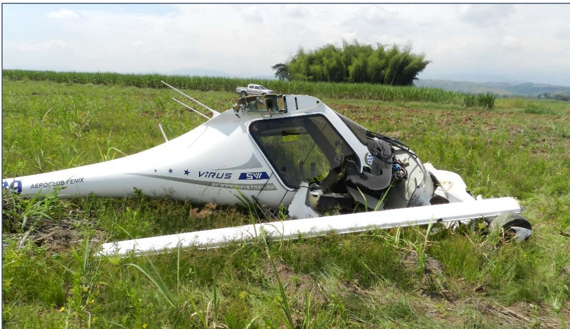
Fotografía No. 3: Desprendimiento del plano derecho del HJ439
