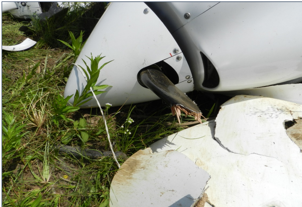
Fotografía No. 5: Ruptura de la pala de la hélice HJ439
