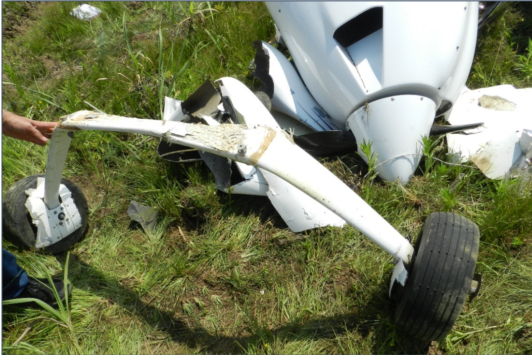
Fotografía No. 4: Desprendimiento del tren principal del HJ439
